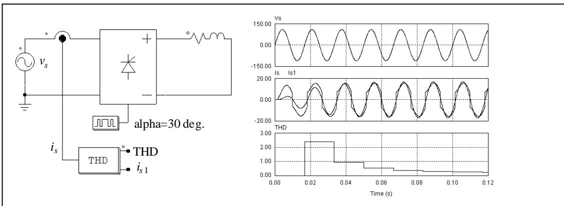
THD ブロックの出力の一方は入力電流の基本波成分  $i_{s1}$  です。入力電圧  $v_s$  と電流  $i_s$  の位相を比べることにより、入力の等価力率を計算することができます。この値を高調波の値(THD)と組み合わせることにより、入力の力率を求めることができます。
