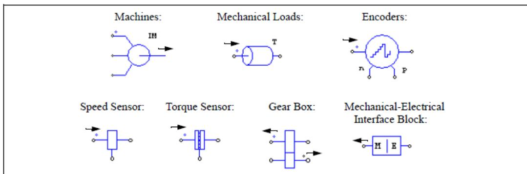
各素子および機械系全体の基準方向(reference direction)に基づいて、各素子の機械系への影響が定まります。
