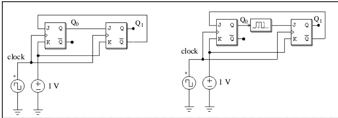
上の回路では、初期値  $Q_0$  と  $Q_1$  はいずれも零と仮定しています。クロックの立ち上がりにおいて、 $Q_0$  は 0 から 1 に状態変化します。伝搬遅れなしとすると、 $Q_1$  は  $Q_0$  と同時に 1 に切り替わってしまいます。これを防ぐために、右の回路では 1 タイムステップの時間遅れを持つ時間遅れ要素を  $Q_0$  と次のフリップフロップの入力(J)の間に追加しています。
