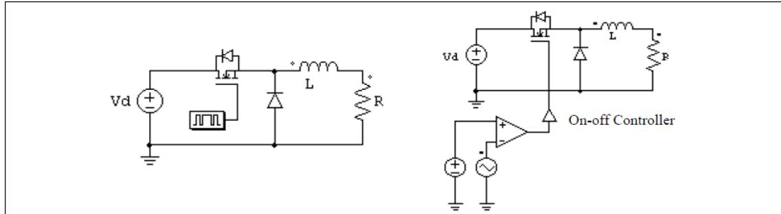
左側の回路はゲートブロックを使用し、右側の回路はオンオフ制御器を使用します。ゲート信号は比較器の出力で決定されます。
