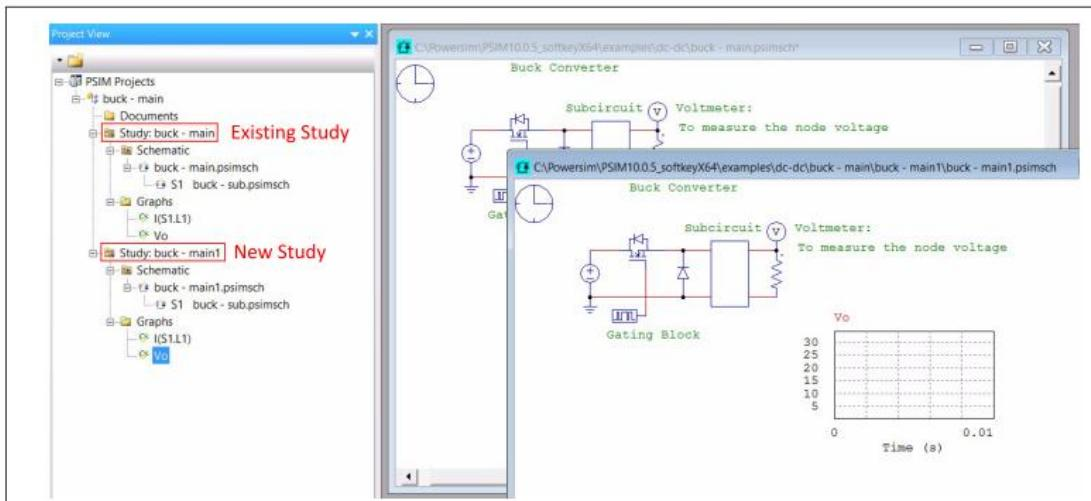
同じプロジェクトの中の別の Study に既存の回路図ファイルを追加するには、「buck - main」のプロジェクトを右クリックして「Add Study(スタディの追加)」を選択します。プロジェクトを保存するにはプロジェクトを右クリックして「Save Project(プロジェクトを保存)」を選択します。
