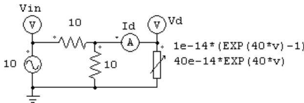
上の回路で、非線形素子(NONI)が非線形ダイオードを模擬しています。ダイオードの電流は電圧の関数で  $i = 10^{-14} \cdot (e^{40v} - 1)$  と与えています。
