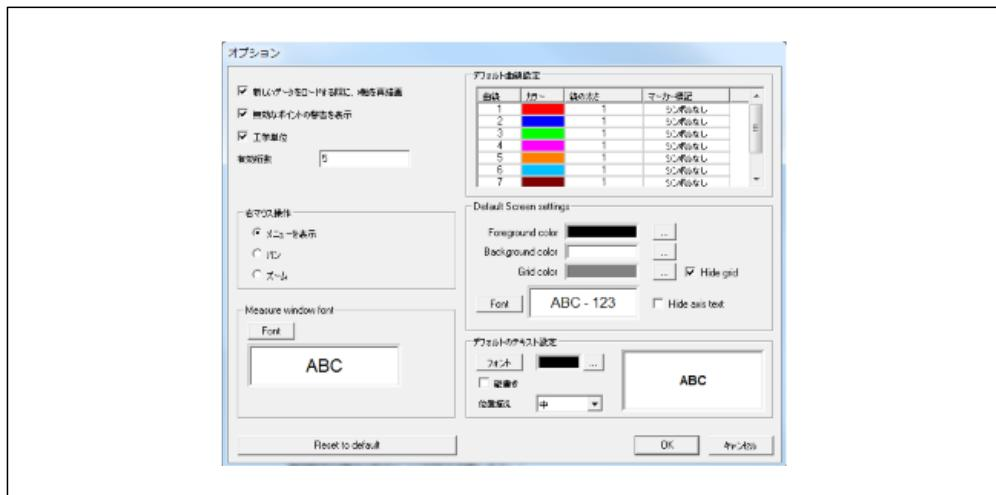
デフォルト曲線設定は曲線の色、線の太さ、およびマークのシンボルなどが定義されています。また、デフォルトのテキスト設定はフォント、サイズ、色などが定義されています。
