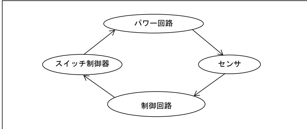
パワー回路はスイッチング素子、RLC 回路、変圧器、および相互結合インダクタなどから構成されます。制御回路は s 領域あるいは z 領域の伝達関数のブロック線図で表現されます。また、制御回路では、アナログ素子(乗算器や除算器など、非線形素子を含む)およびデジタル素子(論理ゲートおよびフリップフロップ)を使用することができます。センサはパワー回路の電圧・電流値を計測します。これらの計測値を制御回路ブロックに渡すこともできます。制御回路で生成されたゲート制御信号はスイッチ制御ブロックを経て、パワー回路のスイッチング素子に送られます。
