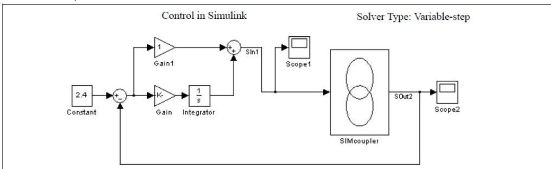
Simulink のタイムステップは PSIM と同一であることを推奨しますが、Simulink の側のタイムステップがわずかに PSIM のタイムステップよりも長い場合にも、充分な精度でシミュレーション結果が得られることがわかっています。上の例では、Simulink のタイムステップは PSIM よりも 10 倍も長い 20μs になっています。
