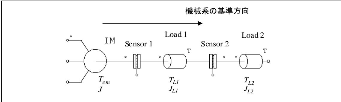
この機械系は 1 つのモータ、2 つのトルクセンサ、2 つの負荷からなります。モータと負荷のトルク( $T$ )と慣性モーメント( $J$ )は図に示すとおりです。基準方向はこの場合、左から右です。この系の運動方程式は次のようにになります。
