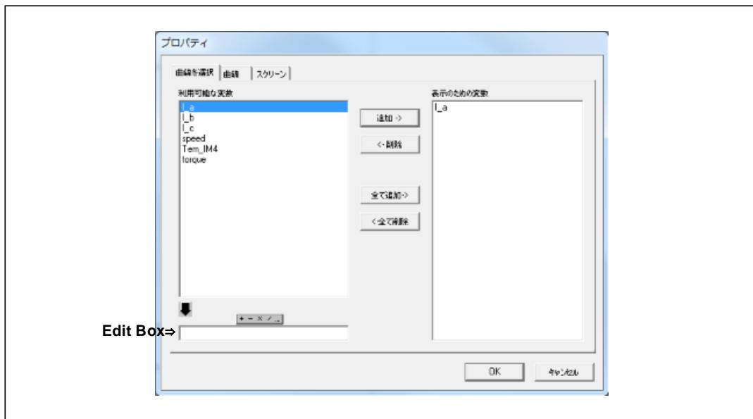
「Edit Box」では、「利用可能な変数」のボックスにリストされている変数をパラメータとして演算処理を行うことができます。次の演算子および括弧を使うことができます。
