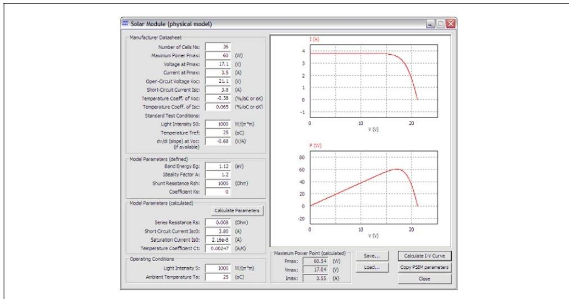
詳細モデルのパラメータの一部はデータシートから得ることができますが、残りは実験データから決定します。詳細モデルのパラメータをデータシートから得るためのツールとして、Utilitiesメニュー内に Solar Cell (Physical Model)が用意されています。
