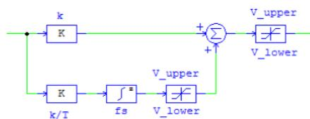
**5.6.6.4 リセット付きデジタル PID 制御器(Digital PID Controller with Reset)**
