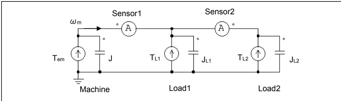
等価回路のノード電圧が機械系の速度  $\omega_m$  に対応します。左側の電流プローブがトルクセンサ 1(Sensor 1)の出力に相当します。同様に、右側の電流プローブはトルクセンサ 2(Sensor 2)の計測値を示します。右側の電流プローブは極性が反転していることに注意してください(右から左)。これはトルクセンサ 2 が機械系の基準方向と反対の方向を計測しているからです。
