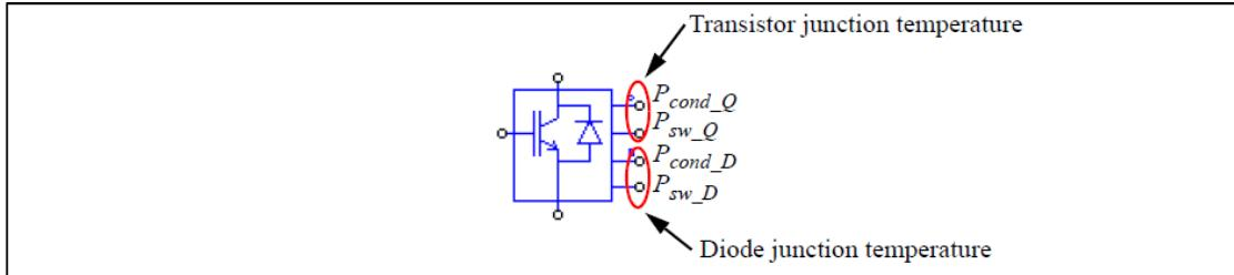
データベースの曲線から損失を算出する際に、算出されたジャンクション温度  $T_{j,Q}$  および  $T_{j,D}$  は使用されます。算出されたジャンクション温度が 2 つの曲線のジャンクション温度の間にある場合、値の補間をします。算出されたジャンクション温度が曲線の最低ジャンクション温度よりも低い場合や、曲線の最高ジャンクション温度よりも高い場合、曲線は最低または最高ジャンクション温度に対応する物が使用されます。曲線が一つだけの場合は、その曲線は算出されたジャンクション温度に関係なく使用されます。
