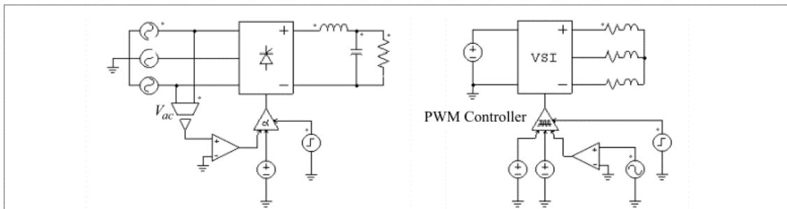
左側のサイリスタの回路は  $\alpha$  コントローラを使用しています。3 相回路では電圧  $V_{ac}$  のゼロクロスは遅延角  $\alpha$  がゼロに等しい瞬間に対応します。この信号はコントローラの同期のために使われます。
