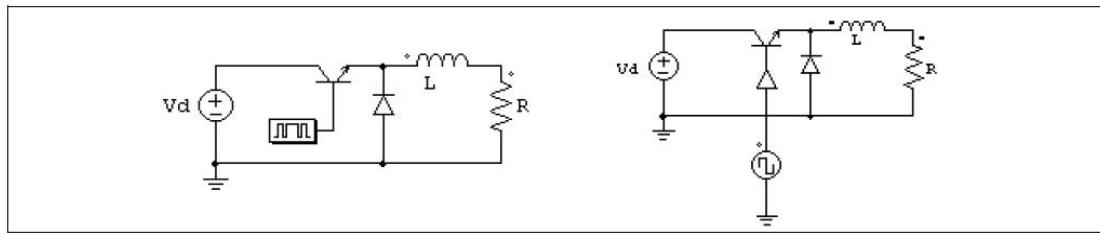
以下の例は npn スイッチを制御するもうひとつの例です。左の回路は実際の回路での npn スイッチを制御する接続を示します。この場合、ゲート電圧  $V_B$  を、変圧器を介してトランジスタのベース駆動回路に加えると、ベース電流がトランジスタの導通状態を決めます。
