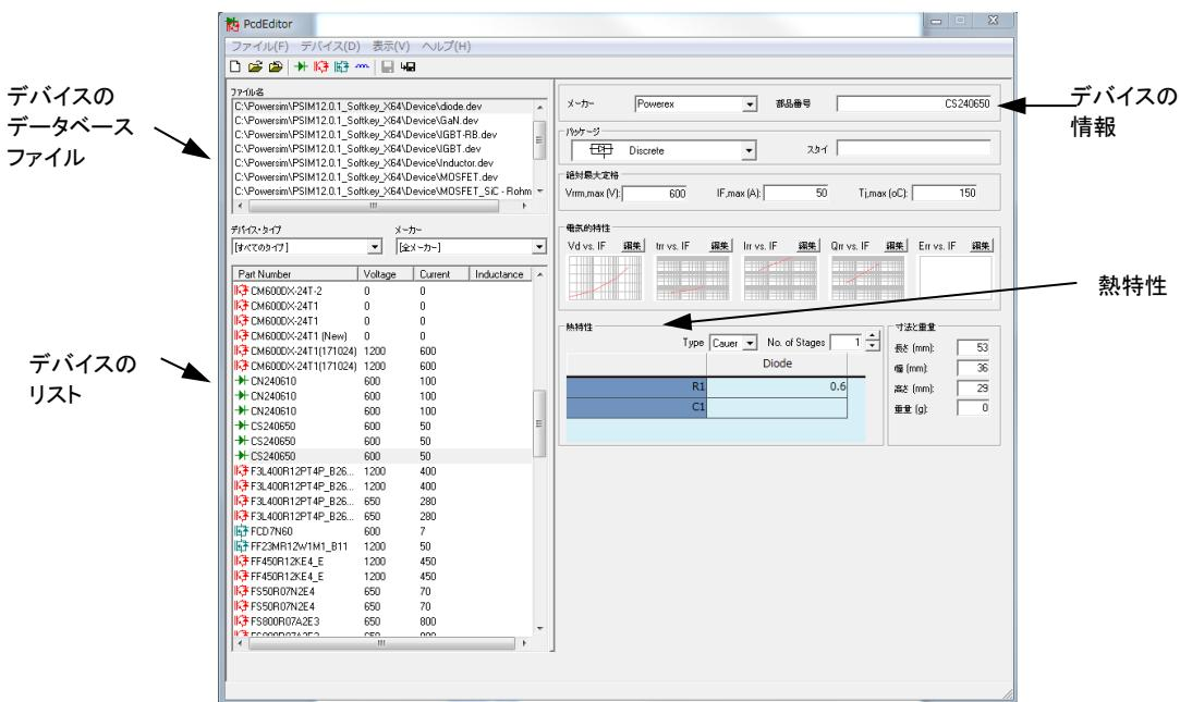
左側には、データベースからロードされるデバイスデータベースファイルおよびデバイスのリストがあります。デバイスはデバイスのタイプかメーカーのいずれかに基づいて表示することができます。さらに、リストのタイトルバーをクリックすることにより、部品番号、定格電圧あるいは定格電流によってデバイスリストをソートすることができます。
