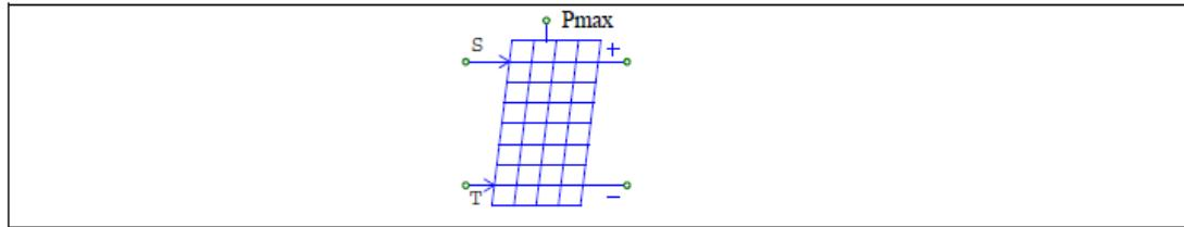
シンボルの"+”と"-”のノードはそれぞれ正と負の端子を表しています。“S”で示したノードは光強度入力(W/m<sup>2</sup>)を、“T”で示したノードは周囲温度入力(°C)を表します。上部のノードは、この動作条件で与えられる理論上の最大電力(W)になります。正負端子のノードがパワー回路用なのにに対し、その他のノードはすべて制御回路用になります。
