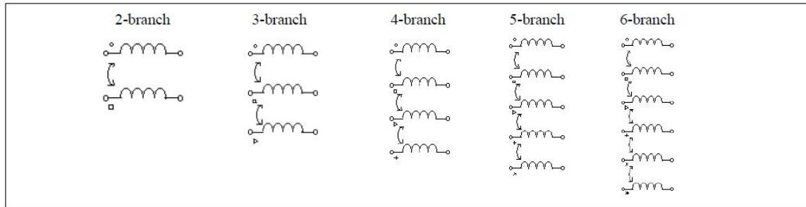
上図シンボルでは、○がインダクタ1、□が2、△が3、+が4、×が5、\*が6の入力端子を示します。
