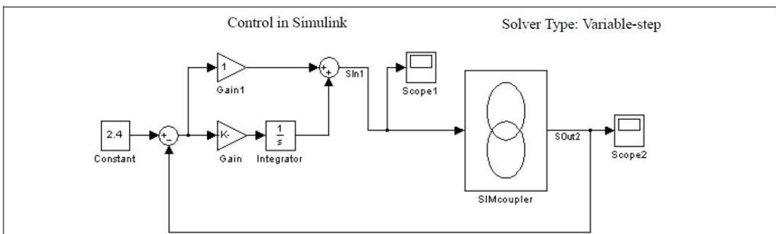
Simulink の Solver Type を **Variable-step** に設定した場合は、正しい結果を得るには SimCoupler の入力にゼロ次ホールドを使う必要があります。さらに、ゼロ次ホールドのサンプル時間は PSIM のタイムステップと同じに設定する必要があります。下の図にこのような構成を示します。
