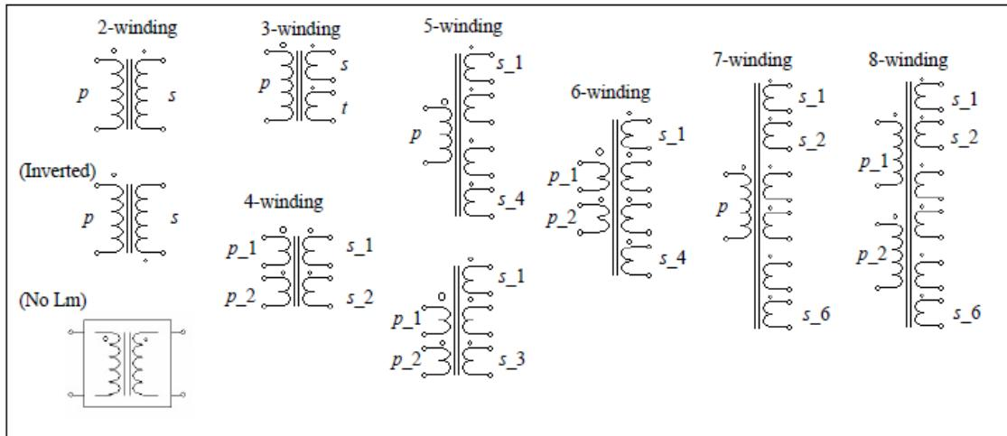
シンボルでは、pは一次側を、sは二次側を、tは三次側を表します。大きなドットの付いた巻線が一次巻線を表します。多巻線変圧器については、巻線の順番は上から下に數えます。2または3巻線変圧器についての仕様は以下のようになります。
