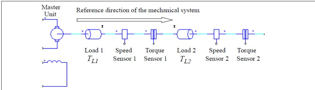
この機械系では、左側のモータがマスタで右側がスレーブです。そのため、機械系の基準方向は機械シャフトに沿って左側から右側に定義されます。さらに、基準方向が素子のドットで表した側に入ると、その素子は基準方向に沿っていると言えます。そうでなければ、基準方向に対して逆ということになります。例えば、負荷 1、スピードセンサ 1、トルクセンサ 1 は基準方向に沿っています。そして負荷 2、スピードセンサ 2、トルクセンサ 2 は基準方向に対して逆となっています。
