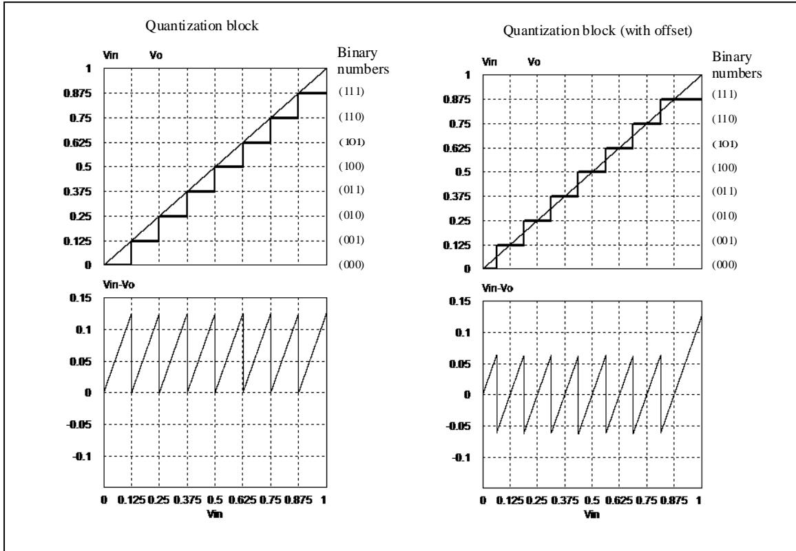
左の波形に示すように、離散化ブロックの離散化誤差は 0~1LSB、または  $1/2^3$ (または 0.125)となります。オフセット付きの離散化ブロックでは、離散化される前に  $0.5 \times \text{ LSB}$  の値が入力に附加されます。これは右の波形に見られるように、離散化誤差を -0.5LSB から +0.5LSB まで減らします(入力が最大値に近い場合を除く)。
