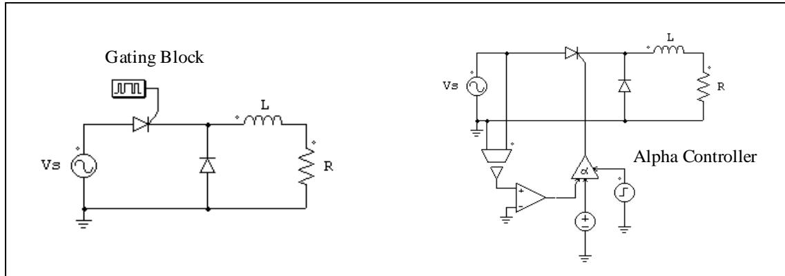
左側の回路はスイッチ・ゲート信号ブロックを使っています。スイッチング・ゲートパターンと周波数はシミュレーション開始前に設定し、シミュレーション中に変化することはできません。右側の回路は点弧角制御器を使っています。遅れ角  $\alpha$ (度)は回路の直流電圧源により指定されます。
