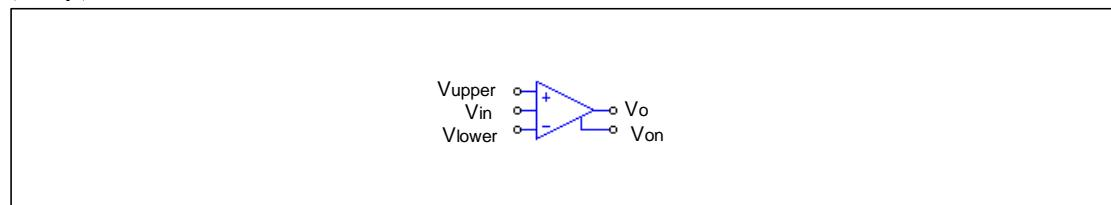
ノードの定義は上図のようになります。出力  $V_{on}$  は出力  $V_o$  と相補性があります。
