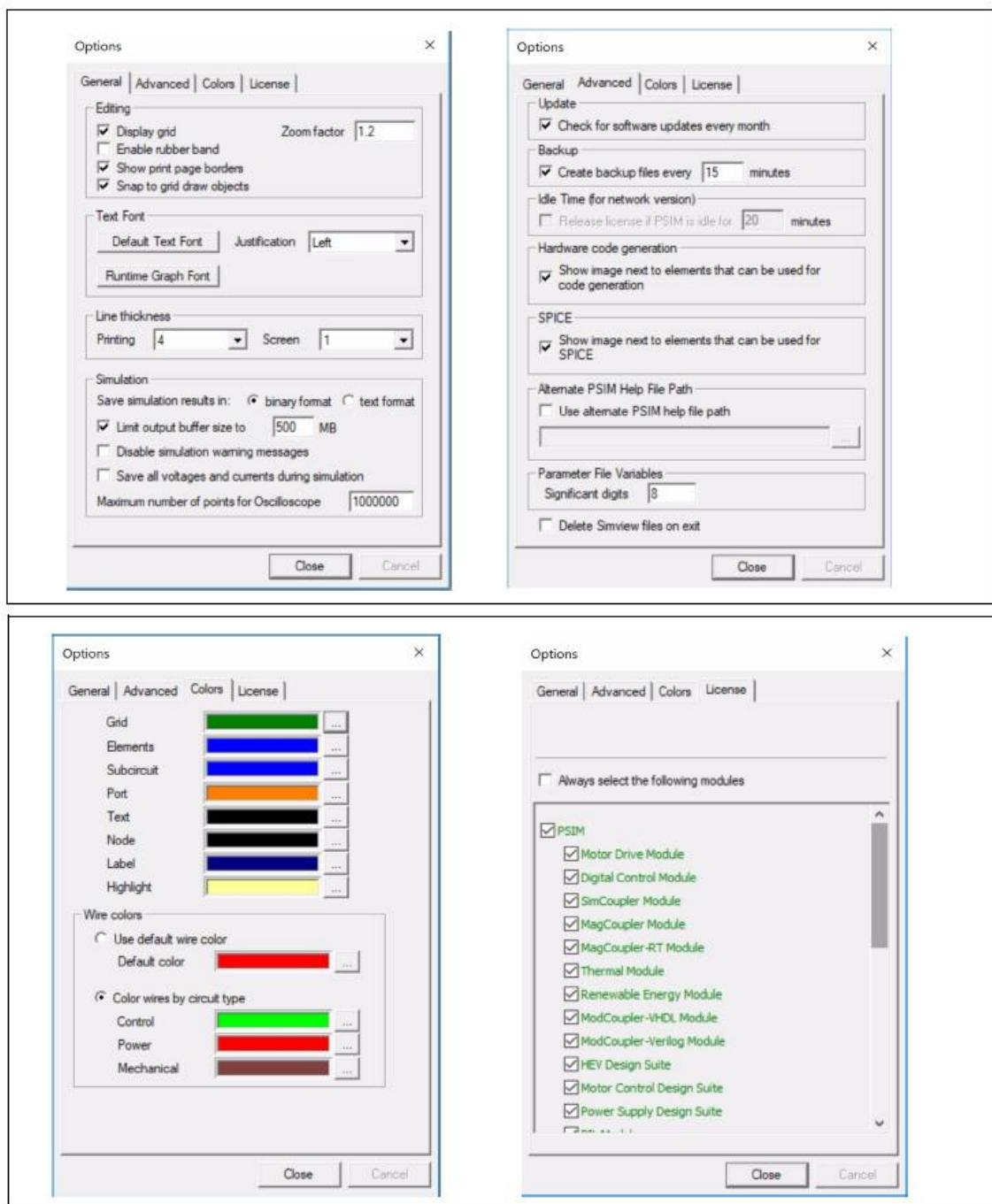
[一般的情報タブ]は、**編集**、**テキストフォント**、**印刷**、**シミュレーション**に分類されます。
