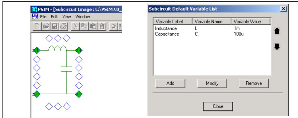
次に、**サブ回路 > デフォルト変数リスト編集** から、デフォルト変数に変数 L および C を追加してください。デフォルト変数リストからパラメータ情報を取得する素子として登録するために必要です。
