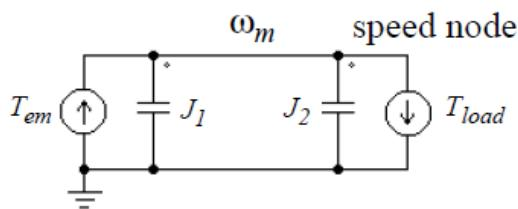
この回路では、2つの電流源を  $T_{em}$  と  $T_{load}$  の値に設定し、キャパシタで  $J_1$  と  $J_2$  を表現しています。また、ノード対地電圧(速度ノード電圧)は機械系の回転速度  $\omega_m$  に対応します。これは  $C = J_1 + J_2, V = \omega_m, i = T_{em} - T_{load}$  とすればキャパシタの方程式  $C \cdot dV/dt = i$  に等価です。
