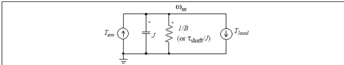
この回路は、軸の時定数  $T_{shaft}$  が抵抗  $1/B$  とキャパシタ  $J$  による RC 時定数と等しいことを示します。したがって、軸の時定数は以下の試験によって測定することが可能です。
