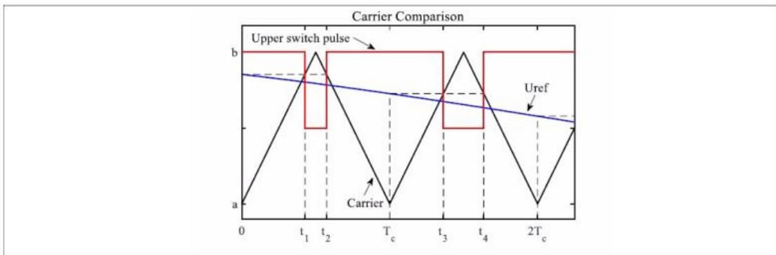
入力信号は前図の  $U_{ref}$  です。このコントローラは入力信号をサンプリングして三角波と比較し、一対のインターロックスイッチのゲート信号を生成します。
