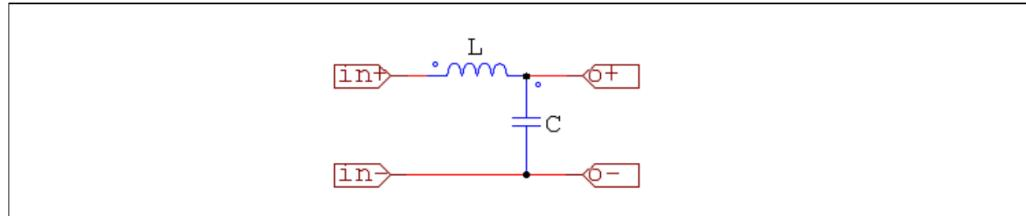
ライブラリに追加するためには、モデルのパラメータ(インダクタンス L およびキャパシタンス C)は、回路図に配置した後に、プロパティウィンドウを通じて設定できる必要があります。そのため、パラメータ L および C は変数として定義する必要があります。
