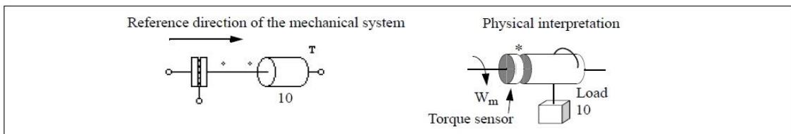
トルクセンサが機械系の等価回路でどのようにモデリングされるかを、以下の図を使って説明します。
