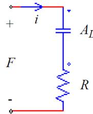
起磁力は、電圧源の形でコンデンサ(静電容量は $A_L$ )と抵抗 $R$ の間に加えられます。インダクタンスファクターは次のように定義されます。
