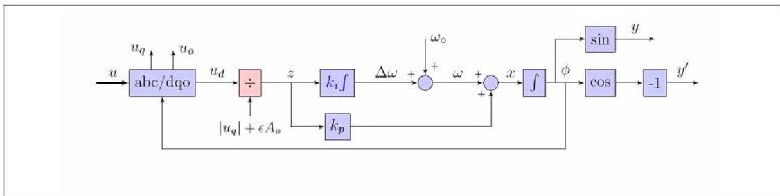
3ph-PLL ブロックは3相平衡もしくはほぼ平衡入力を受け入れます。3ph-ePLL は平衡または非平衡にかかわらず一般的な三相信号を処理します。
