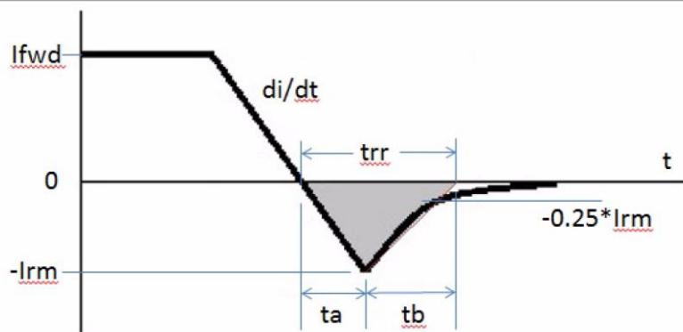
逆回復時間  $trr$  は  $ta$  および  $tb$  に分かれます。 $ta$  の期間では電流値は 0 から  $-I_{rm}$  まで直線的に変化します。 $tb$  は JEDEC(Joint Electron Device Engineering Council)によると、上図のように  $-I_{rm}$  から  $-0.25 * I_{rm}$  までの直線が時間軸と交差するまでの期間と定義されています。
