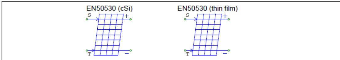
シンボルの "+" と "-" のノードはそれぞれ正と負の端子を表しています。"S" で示したノードは光強度入力 ( $\text{W/m}^2$ ) を、"T" で示したノードは周囲温度入力 ( $^\circ\text{C}$ ) を表します。上部のノードは、この動作条件で与えられる理論上の最大電力 ( $\text{W}$ ) になります。正負端子のノードがパワー回路用なのにに対し、その他のノードはすべて制御回路用になります。
