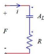
起磁力は、電圧源の形でコンデンサ(静電容量はAL)と抵抗Rの間に印加されます。このブランチを通じて流れる電流をiとし、そのrms値をI<sub>rms</sub>とすると、漏れ磁束の損失と抵抗Rの関係は次のようにになります。
