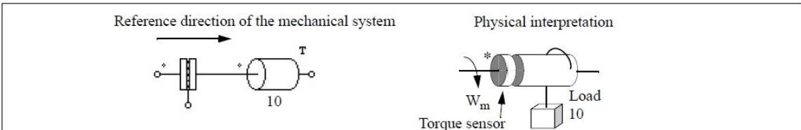
同様に、ドット側が接続されているとき、センサはドット側のトルク強度を計測し、回転速度方向は正方向となります。例として、以下の図のように左右が反転しているトルクセンサを考えます。ドット側が接続されているとき、負荷トルクはセンサのドット側に回転速度方向と逆向きにかかります。トルクセンサ出力は  $-10(N\cdot m)$  になります。
