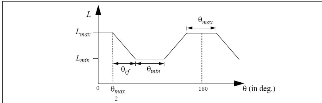
回転角は、固定子と回転子の歯が完全にかみ合っている場合を  $\theta = 0$  とします。インダクタンスの値は、上昇(rising)、頂上(flat-top)、下降(falling)、底(flat-bottom)の 4 段階のいずれかになります。
