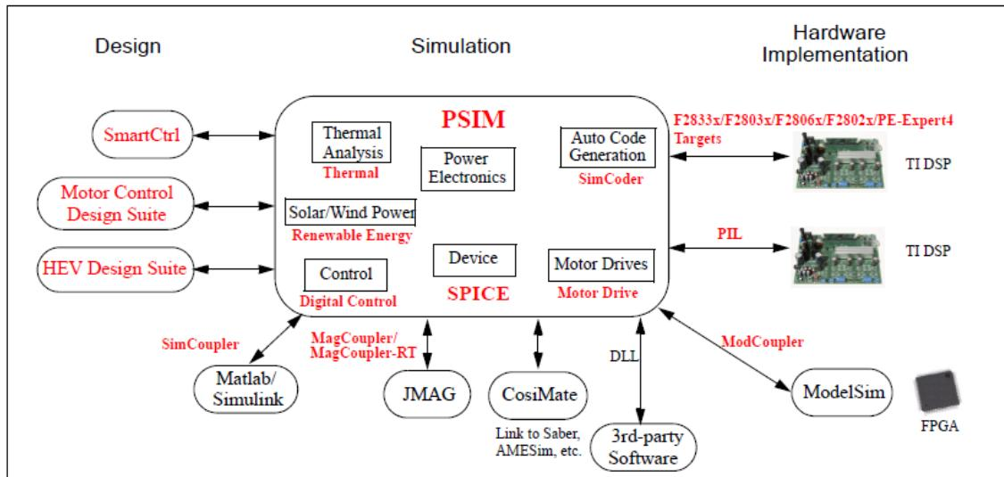
PSIM<sup>1</sup> パッケージは4つのソフトウェアから構成されています。PSIM回路図エディタ、2つのシミュレーションエンジン(PSIMとSPICE)、そして波形表示/処理ソフトのSIMVIEW<sup>1</sup>です。下図にシミュレーション環境を示します。
